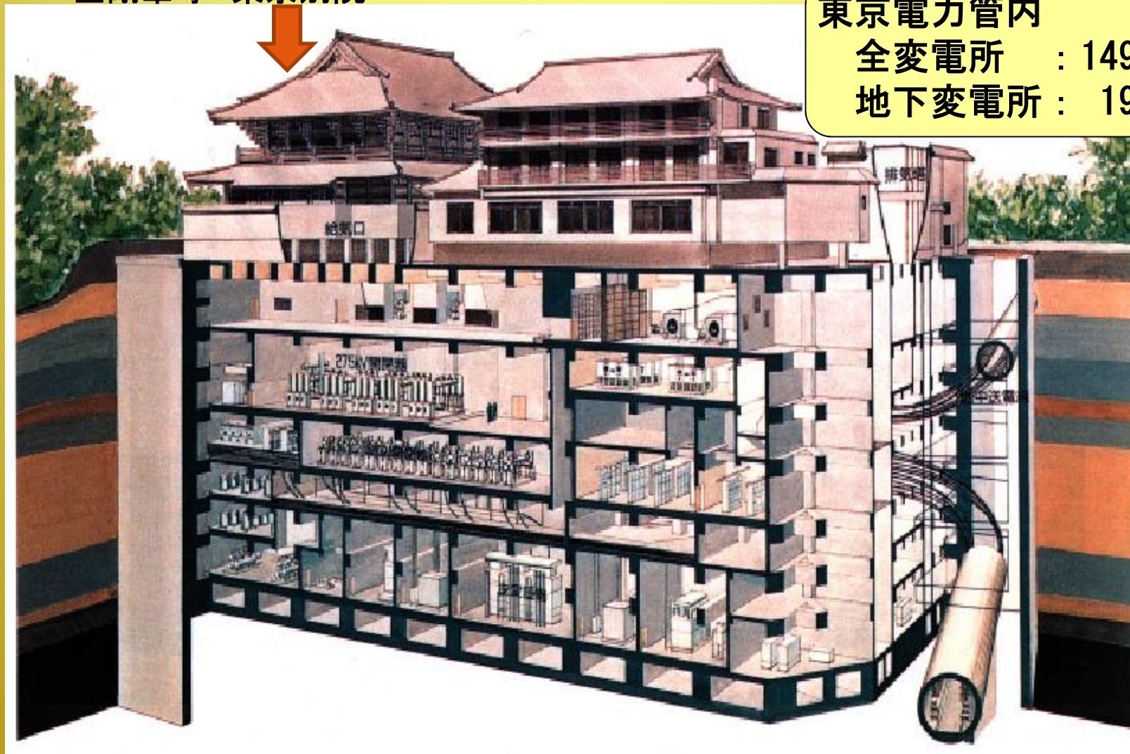
東京電力高輪変電所 275/66kV 900MVA
