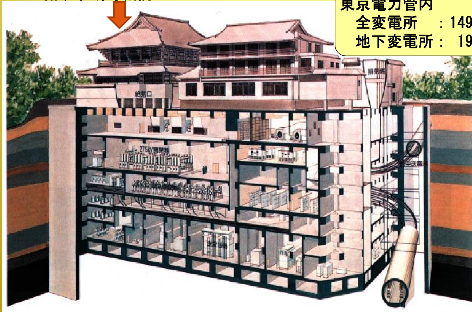
東京電力高輪変電所 275/66kV 900MVA
